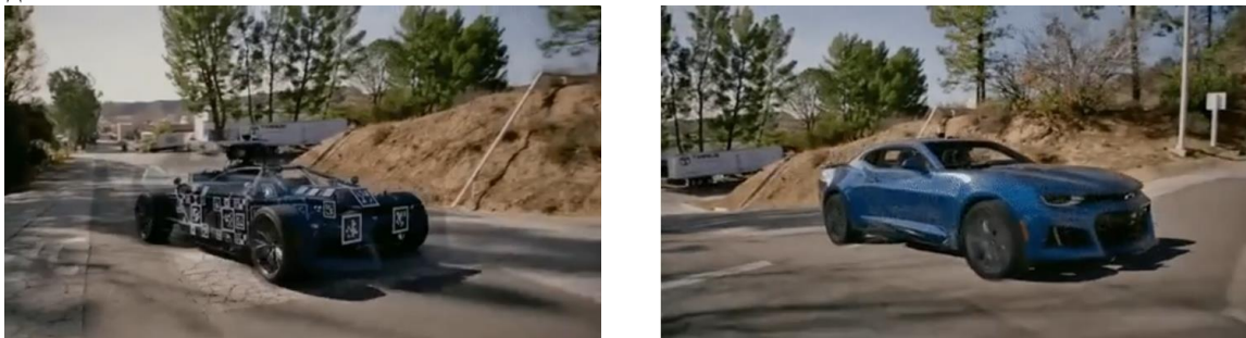
Рис.5. Применение инструмента stagecraft – замена объекта трехмерной моделью в реальном времени (слева – каркас с QR-метками, справа – полученный результат замещения).
