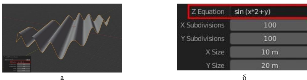
Рис.1. Параметрическая поверхность: а–параметрическая поверхность, сгенерированная математической формулой F(z)=\sin(2x+y) . Функция определяет деформацию по оси Z б – параметры, формирующие поверхность
