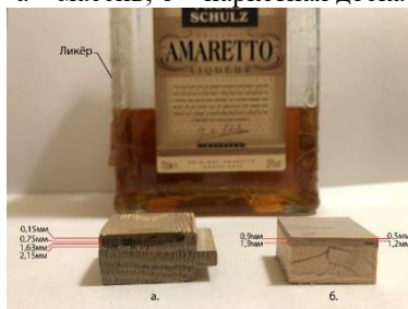
Рис.5. Опыт проникновения ликёра в исследуемые образцы а – массив; б – паркетная доска
