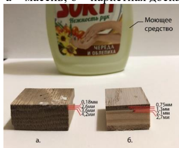
Рис.4. Опыт проникновения моющего средства в исследуемые образцы а – массив; б – паркетная доска
