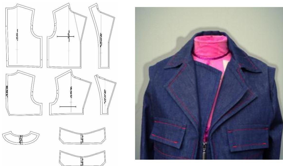
Рис.6. Лекала воротника джинсовой куртки и фотография готового изделия
