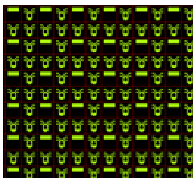
Рис.6. Графическая запись переплетения на участке пояса
