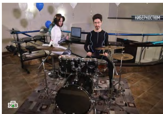
Рис.2. Процесс записи навыка игры на барабане с помощью киберкостюма
