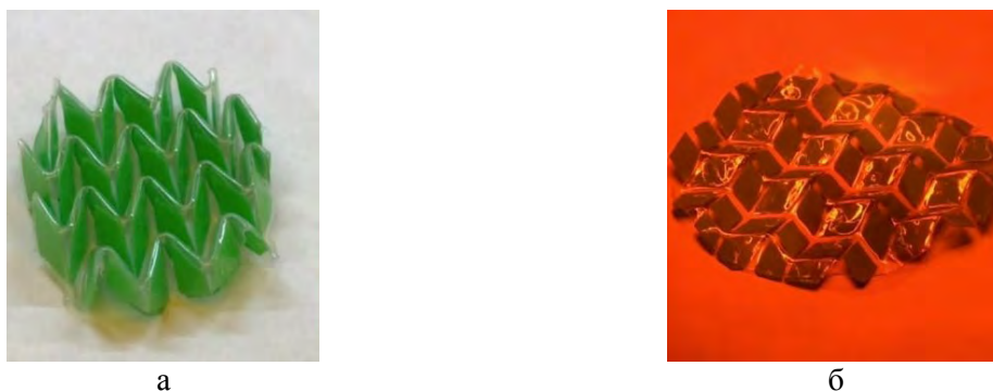
Рис.2. Пример материала, изменяющего линейные размеры а – при нормальной температуре; б – при нагреве
