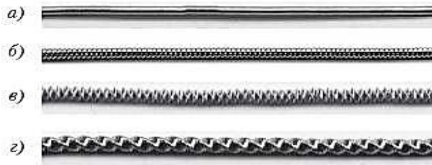
Рис 2. Разновидности металлических нитей а) волоченное золото, б) пряденая нить, в) скань, г) канитель
