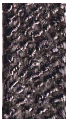
Рис. Внешний вид плетеного углеродного полотна триаксиального переплетения прямого типа с правой третьей системой
