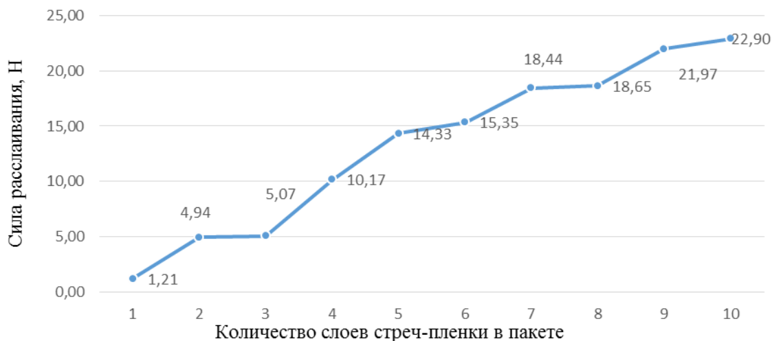
Рис. 4. Зависимость усилия при раслаивании от количества слоев стрейч-пленки
