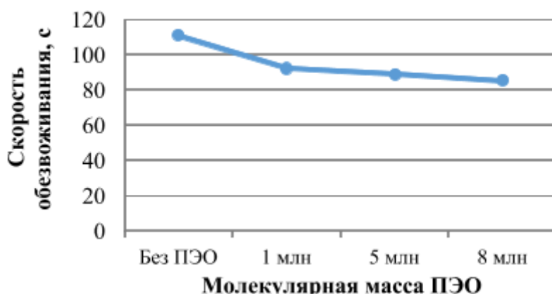
Рис. 1 – Зависимость скорости обезвоживания волокнистой суспензии от молекулярной массы полиэтиленоксида
