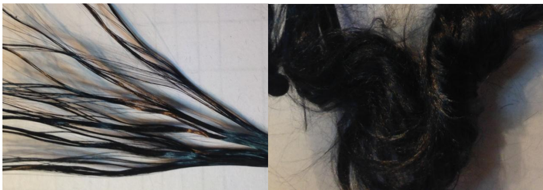
Рис. 1 УВ до импульса током - а) УВ после импульса тока в 10 кА - б)
