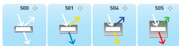
Рис.1. Принцип действия интерференционного пигмента
