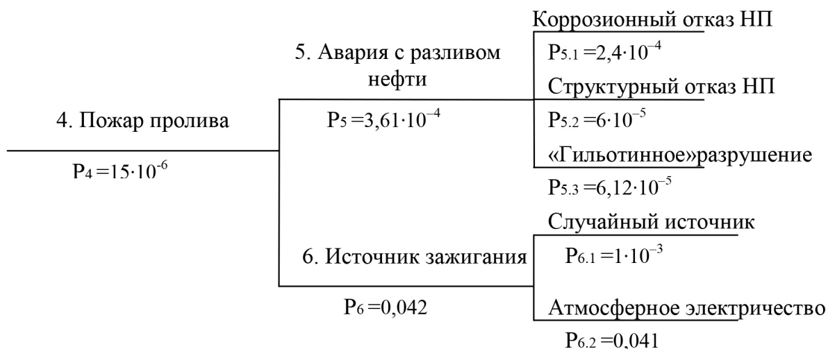
Рисунок 4. Дерево событий для сценария с наиболее тяжелыми последствиями (пожар пролива)
