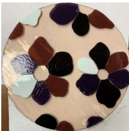
Рисунок 29 – Изделие, подготовленное к температурной обработке в печи
