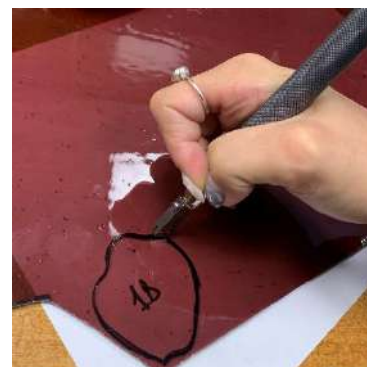
Рисунок 22 – Работа со стеклорезом
