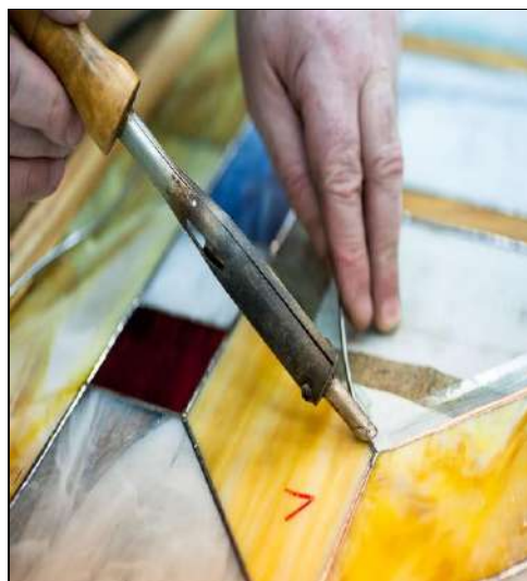
Рисунок 4 – Спаивание витража в технике Тиффани
