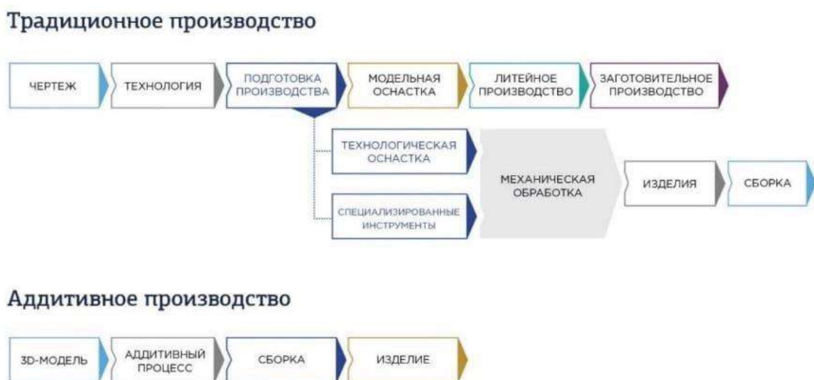
Рисунок 1 – Сравнение этапов традиционного и аддитивного производства
