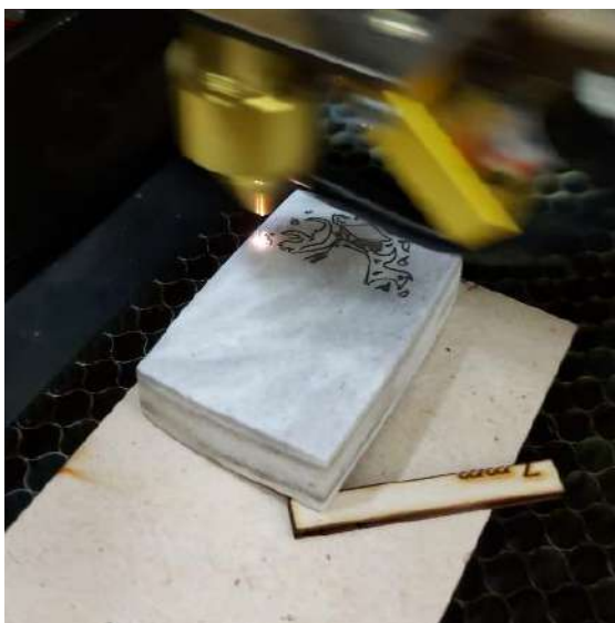
Рисунок 5 - Процесс гравирования заготовок
