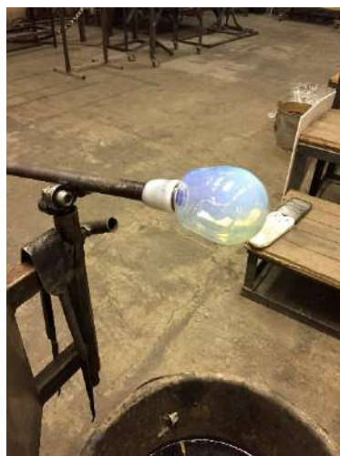
Рисунок 2 – Изготовление заготовки из глушеного стека
