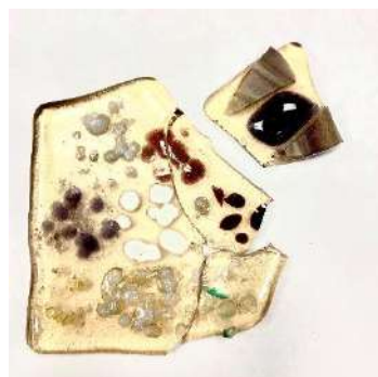
Рисунок 20 – Образец проверки оплавления стекла
