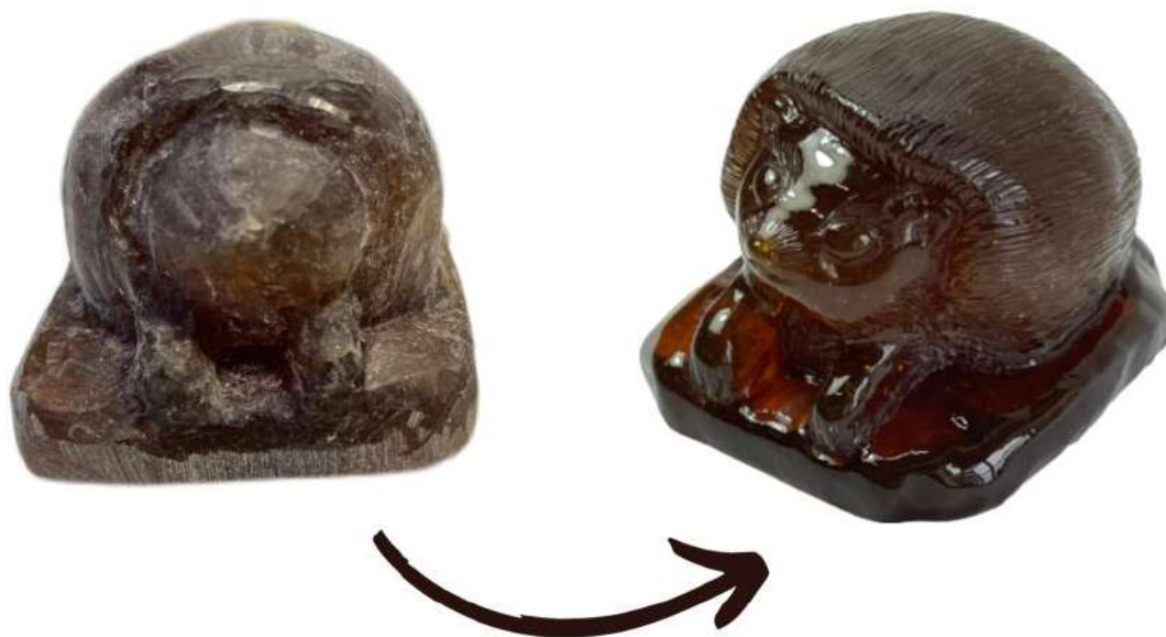
Рисунок 4 – Этапы изготовления готового изделия (первичная шлифовка и полировка)
