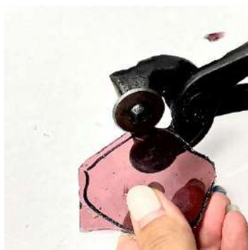
Рисунок 24 – Обработка элемента щипцами для откусывания стекла
