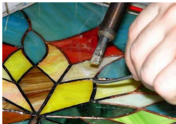
Рисунок 10 – Процесс спаивания деталей
