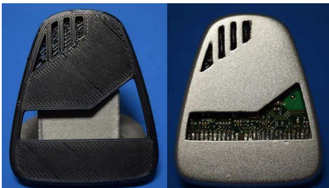
Рисунок 4 – Слева- напечатанная модель на FDM 3D -принтере, а справа- модель после обработки
