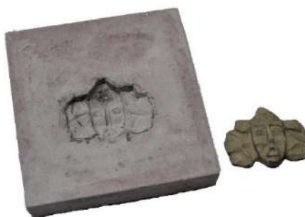
Рисунок 6 – Гипсовая форма и мастер-модель керамической вставки
