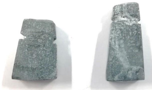
Рисунок 3. Образцы с цинковым покрытием, после испытаний в среде SO 2 Figure 3. Samples with zinc coating, after testing in SO 2 environment
