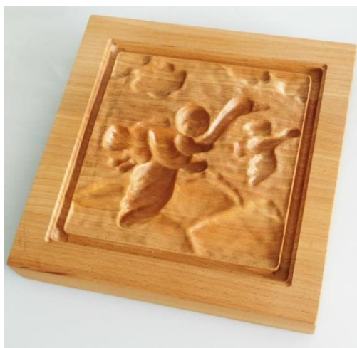
Рисунок 3. Литейная форма из древесины после нанесения пропитки Figure 3. Wood mold after application of impregnation
