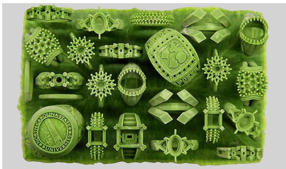
Рисунок 3. Модели, выращенные на станке Invision tec aureus Figure 3. Models grown on the machine Invision tec aureus
