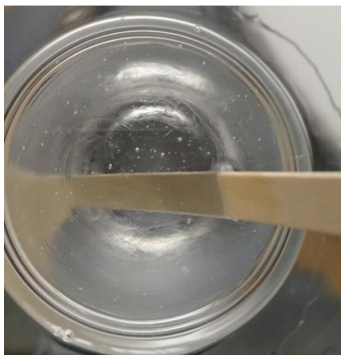
Рисунок 2. Замешивание смолы с отвердителем Figure 2. Mixing resin with hardener
