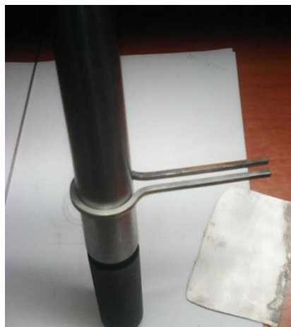
Рисунок 3. Правка проволоки на ригели Figure 3. Edit wire on the crossbar
