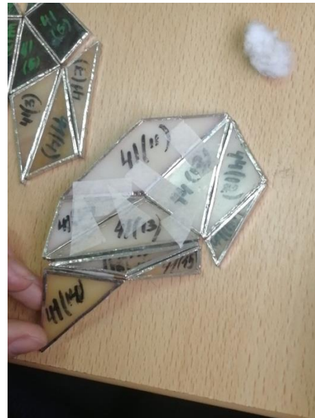
Рисунок 4. Упрочнение конструкции с помощью бумажного скотча Figure 4. Strengthening construction with paper tape
