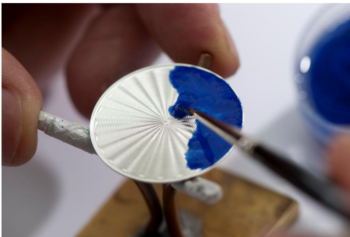
Рисунок 3. Подготовка эмали на гильошированном фон Figure 3. Preparation of enamel on guilloche background
