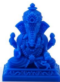
Рисунок 2. Модели, выращенные на станке 3D System projet Figure 2. Models grown on a 3D System projet machine
