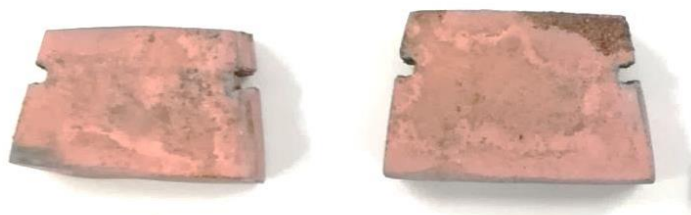
Рисунок 2. Образцы с медным покрытием, после испытаний в среде SO 2 Figure 2. Samples with copper coating, after testing in SO 2 environment
