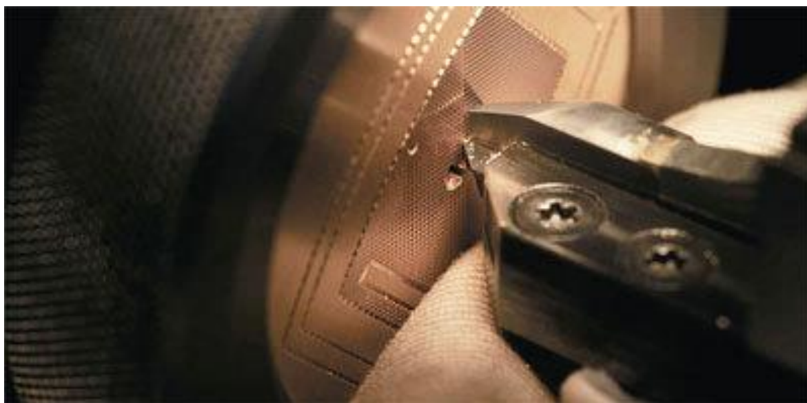
Рисунок 2. Процесс резьбы узора на гильошировочном станке Figure 2. The process of carving the pattern on the guilloché machine
