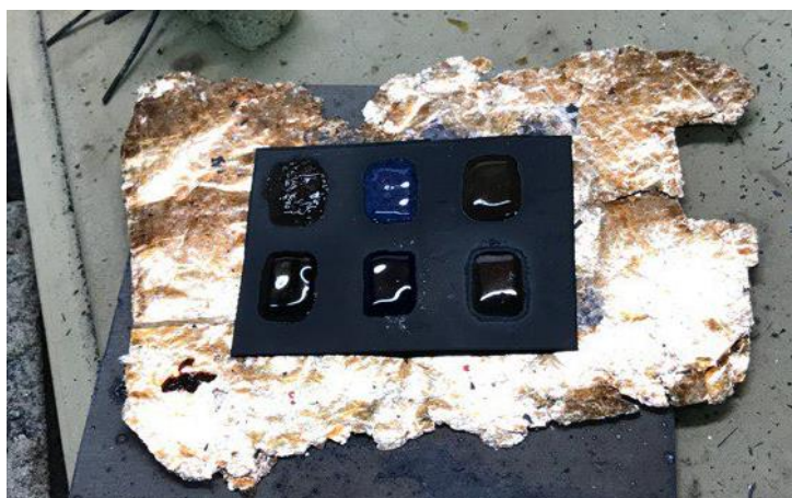
Рисунок 7. Расплавленные пробники смальт на медной подложке Figure 7. Smelt molten probes on a copper substrate
