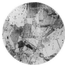
Рисунок 2. Рекристаллизованная медь с примесью кислорода, увеличение \times 250
