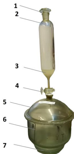
Рисунок 3. Прибор для проведения испытаний в атмосфере с постоянной влажностью, в присутствии коррозионного агента сернистого ангидрида:
