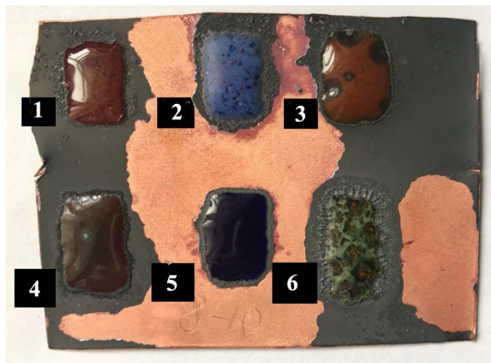
Рисунок 9. Расплавленные образцы смальты: 1,2,3 – современные смальты, 4,5,6 – императорская смальта Figure 9. Melted samples of smalt: 1,2,3 - modern smalt, 4,5,6 - imperial smalt
