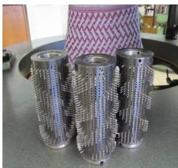
Рисунок 9. Рисунчатые барабанчики кругловязальной машины КЛК – 11 (Россия), 1998 г.
