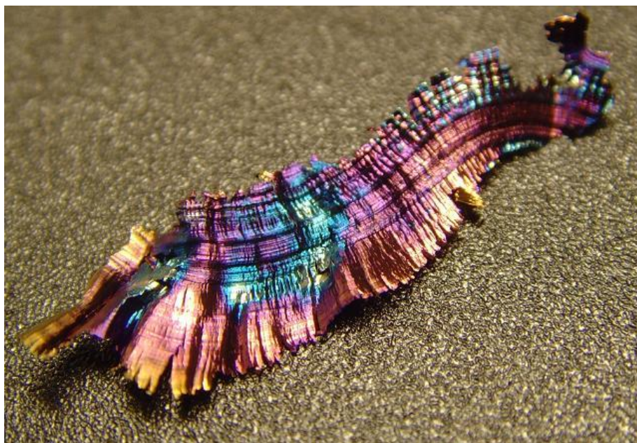
Рисунок 3. Стружка. Цвета побежалости Figure 3. Shavings. Tint colors
