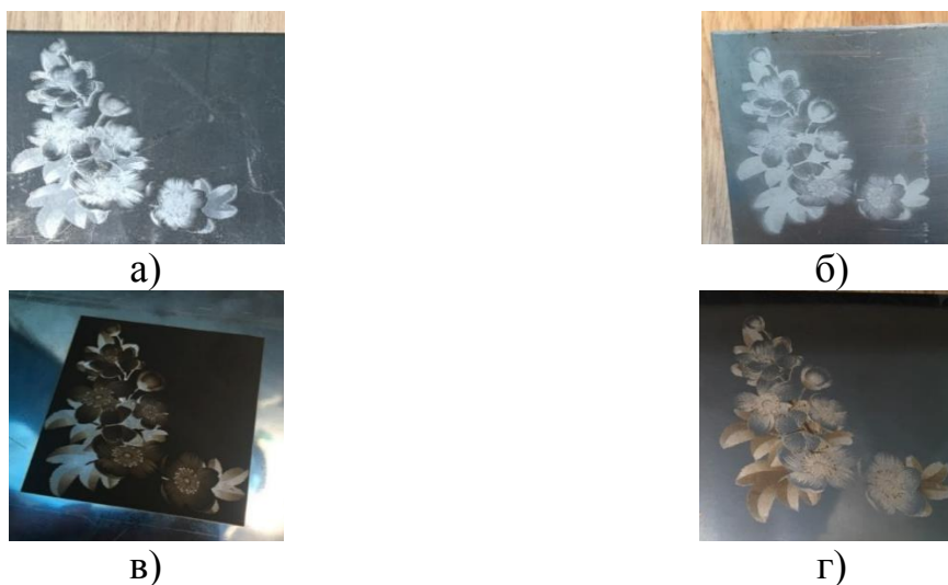
Рисунок 2. наилучшие получившиеся гравированные изображения на а) стали 10, б) алюминии, в), г) нержавеющей стали
